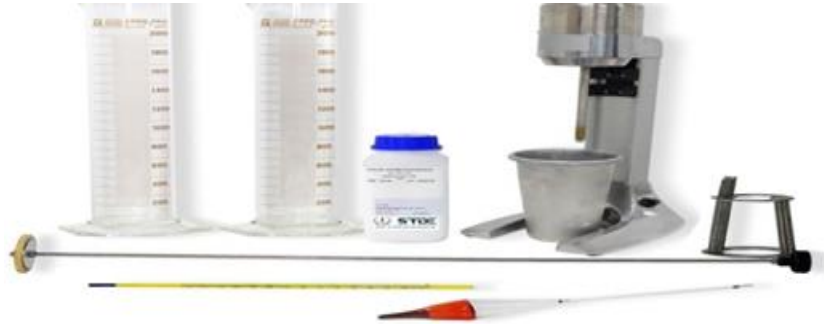
Figure 2.8 : Appareillage complet pour essais de sédimentométrie (norme NF-P94-057)
