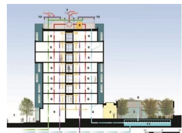
Figure 91: Schéma explicatif sur la gestion de l'eau
