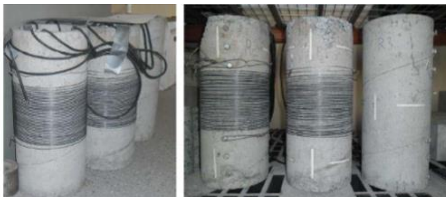
Figure 1.25 : Etude sur des cylindres creux renforcés par fil en AMF. (Waibaye, 2016)
