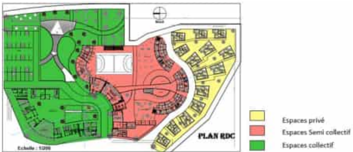
Figure 79: Plan de rez de chaussée. Source Auteur
