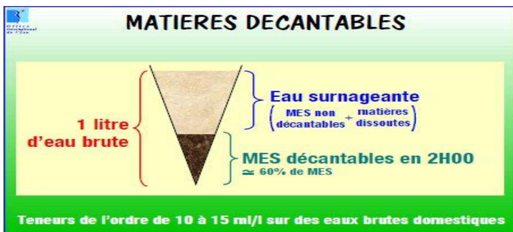
Figure 12: représentation des matières décantables
