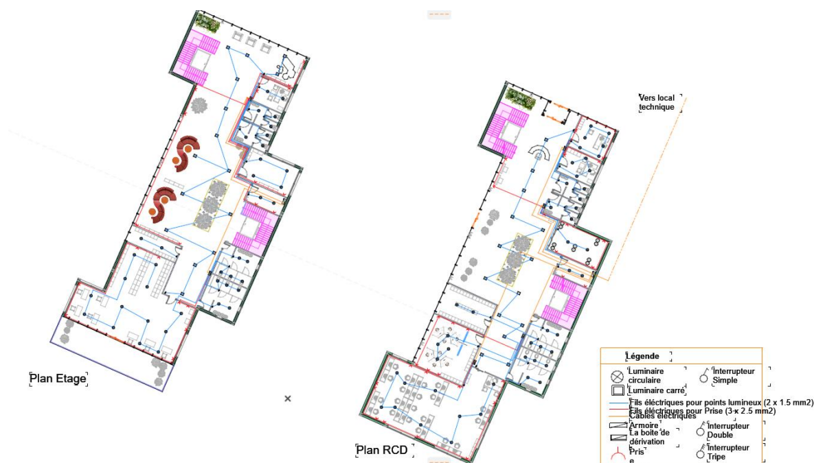
Figure 60 : Plan d'installation électrique
