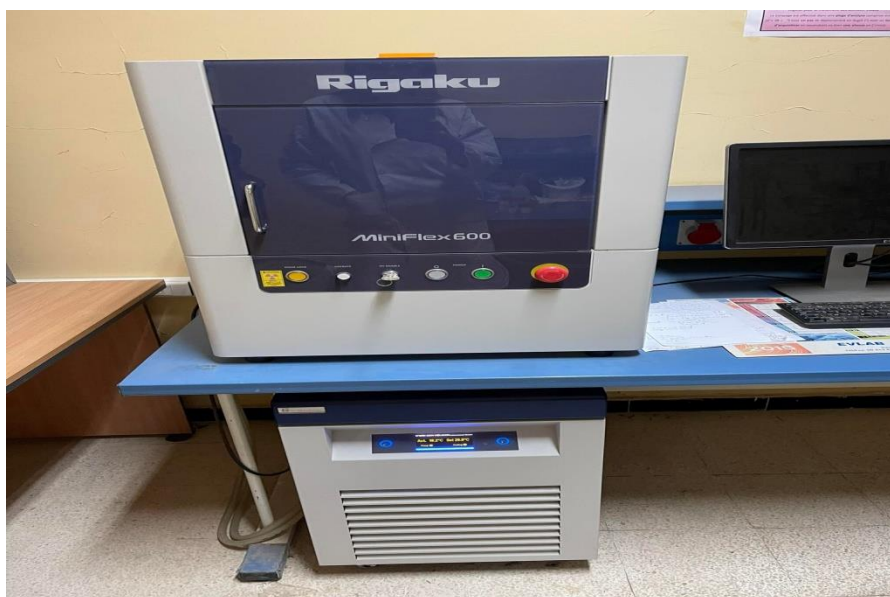
Figure II.2 : Appareil de diffraction des rayons X.
