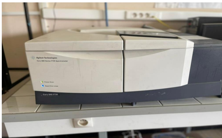
Figure II.4 : Appareil de spectroscopie infra-rouge à transformée de Fourier Agilent Technologies Cary 600 series.
