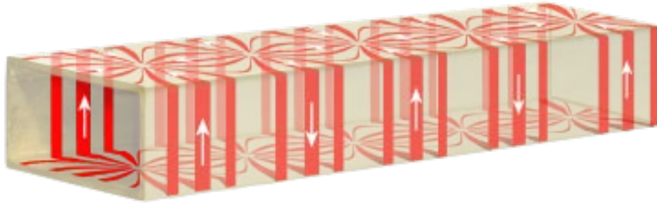
Figure I. 9. Instantané des courants induits dans les murs du guide d'onde par une onde TE_{10} .
