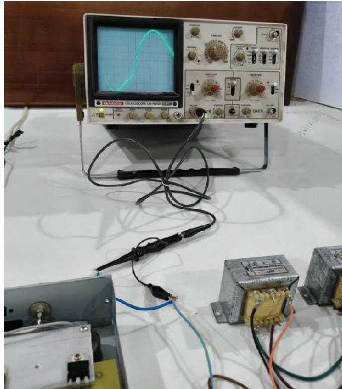
Fig.3.16 : Mesure de la tension de sortie à l'oscilloscope
