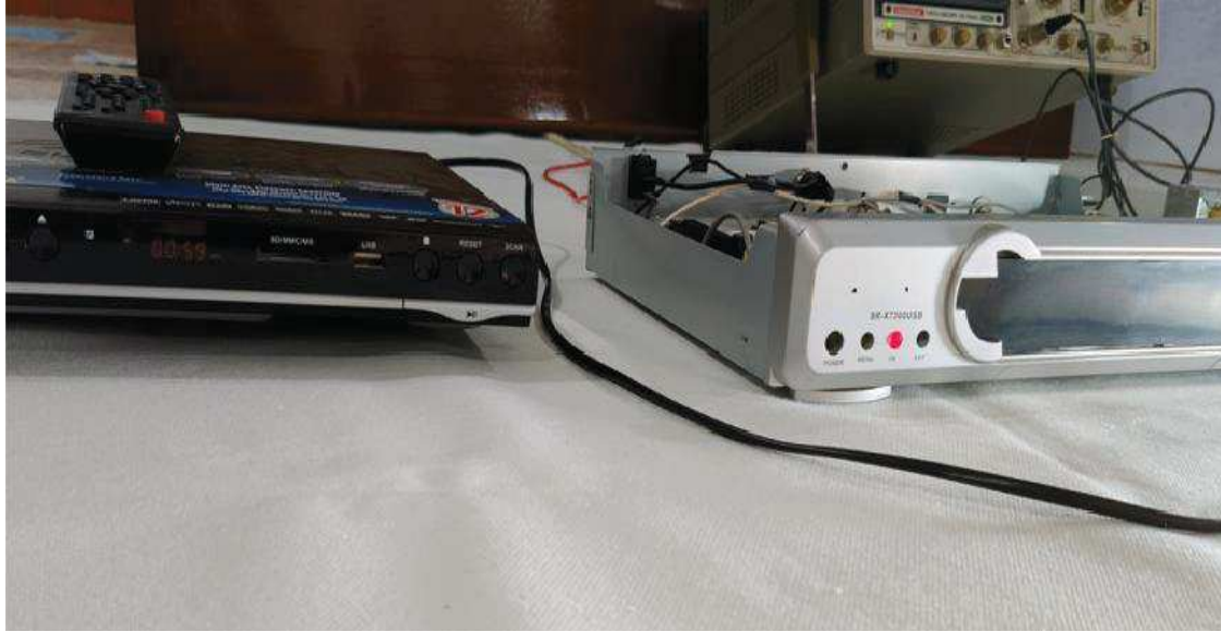
Fig.3.18 : L'onduleur en état de marche avec le VCD en position Play et la lampe allumée
