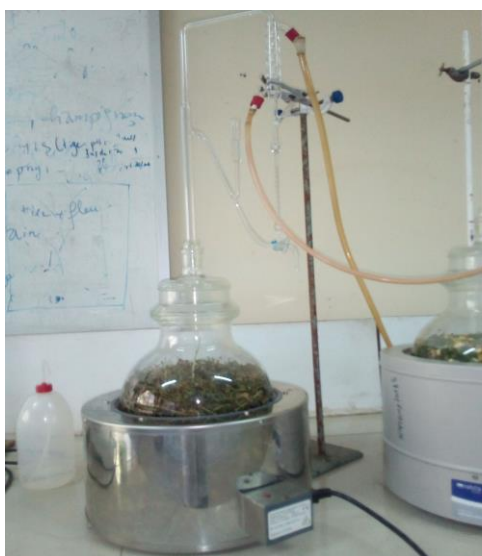
Figure 10 : Montage d'hydrodistillation de type clevenger.
