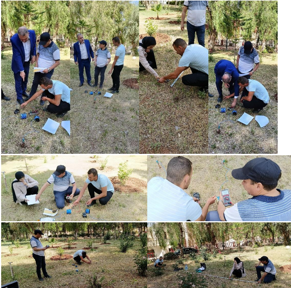
Figure 60 : Essai d'étalonnage de l'appareil de Winner-Schlumberger au niveau du site de la faculté
