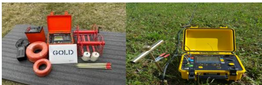
Figure 10 : Instrument de géophysique des détecteurs d'eau souterraine
