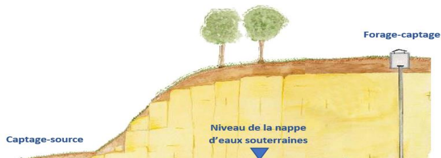
Figure 21 : Schéma explicatif d'un captage-source et d'un forage-captage
