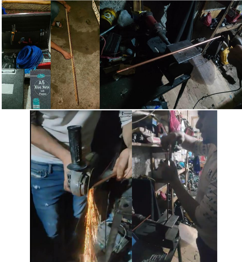
Figure 58 : Photos de confection de l'appareil de Winner-Schlumberger
