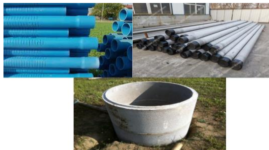
Figure 36 : Tubage du puits en PVC béton acier
