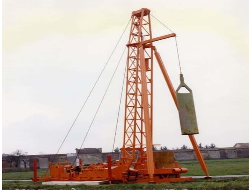
Figure 26 : Forage par percussion
