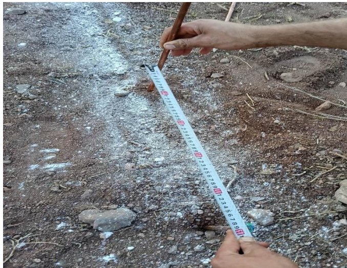
Figure 64 : Installation des électrodes
