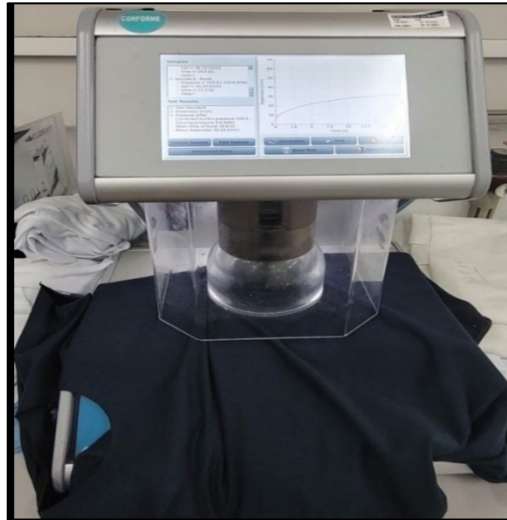
Figure II.32 : Machine de teste de la résistance à l'éclatement
