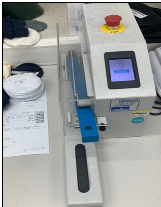
Figure II.33 : Machine de test de la solidité de couleur au frottement
