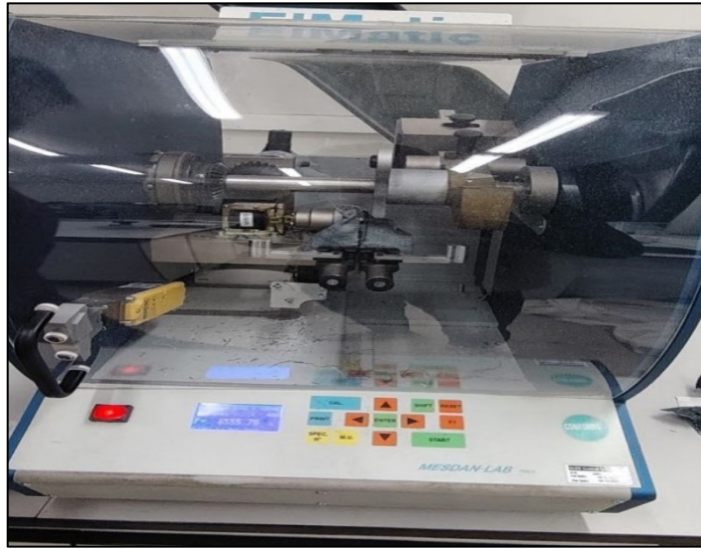
Figure II.30 : Machine de la résistance à la déchirure
