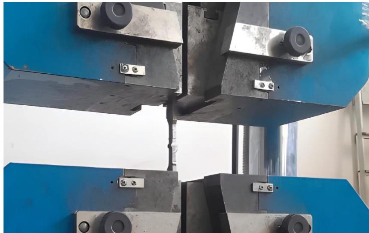
Figure 3. 2 : Epreuve de traction avant la rupture dans la machine de traction
