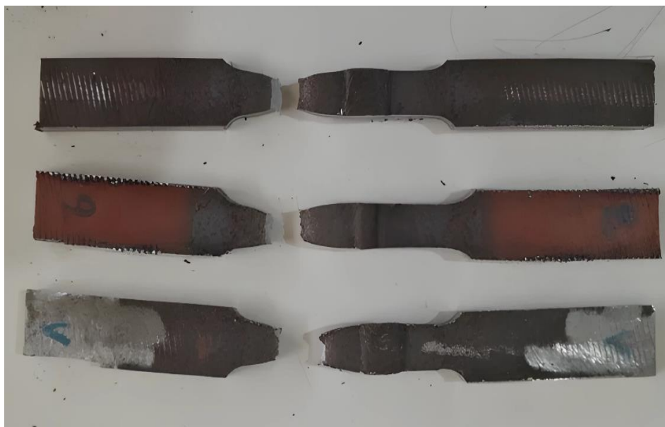
Figure 3. 5 : Photos des éprouvettes soudées après la rupture
