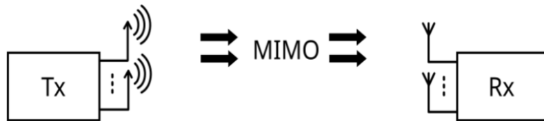
Figure II.9 : Schéma d'un système MIMO.
