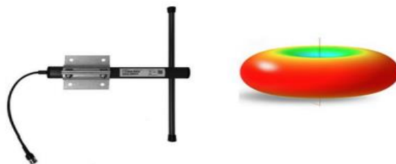
Figure I.14 : L'antenne dipôle et son diagramme de rayonnement.
