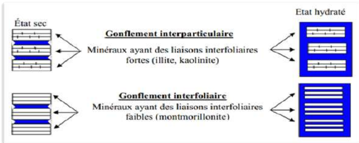
Figure I.3 : Mécanismes de gonflement des argiles par hydratation.
