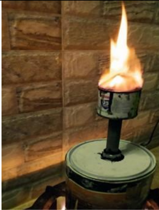
Figure II.6 : image explicative du système utilisé pour la gazéification et de flamme résultante
