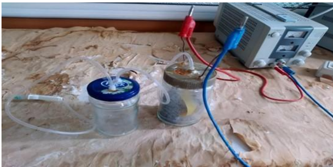
Figure III.1 : montage expérimentale de la méthode d'électrolyse d'eau
