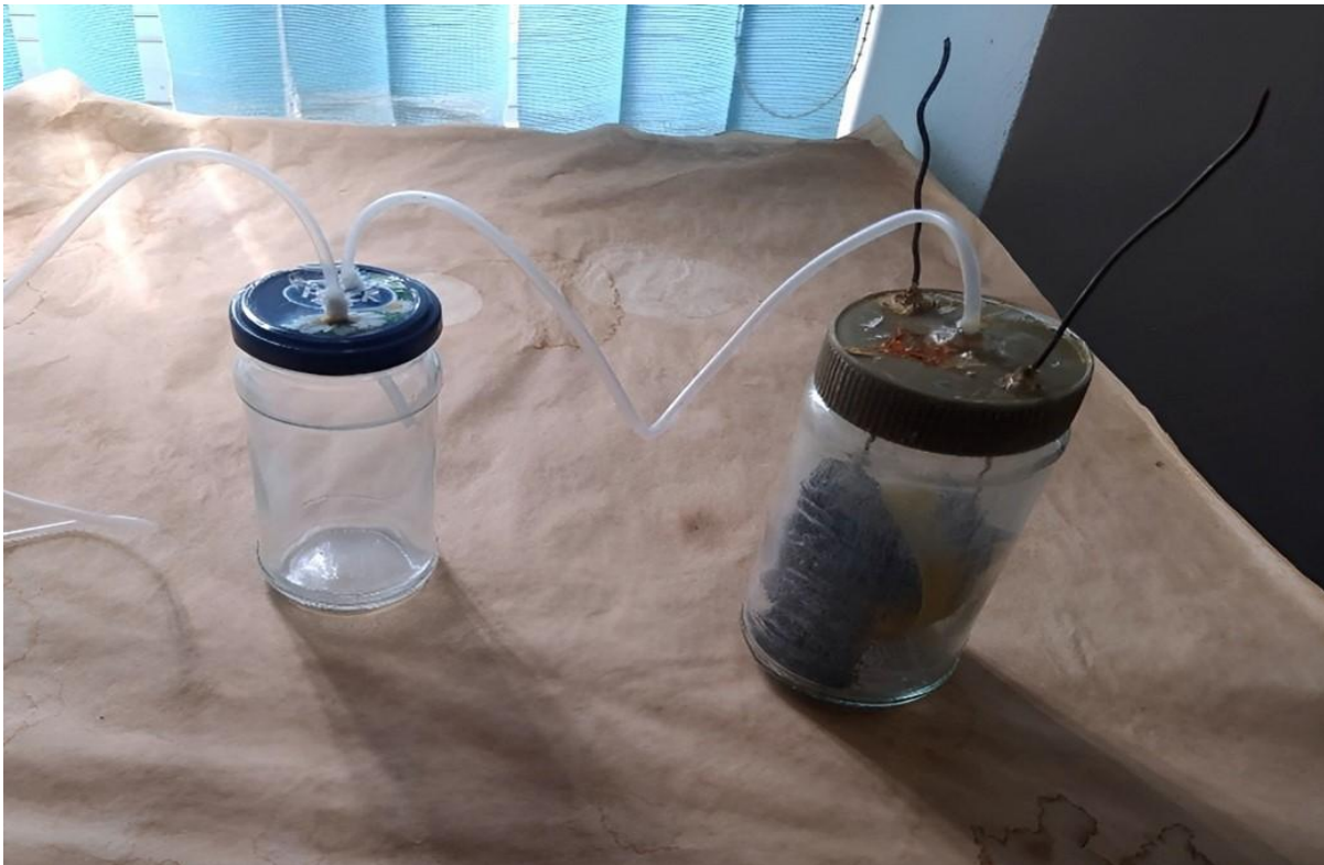
Figure II.2 : Connexion de l'électrolyseur au réservoir par un tuyau transparent
