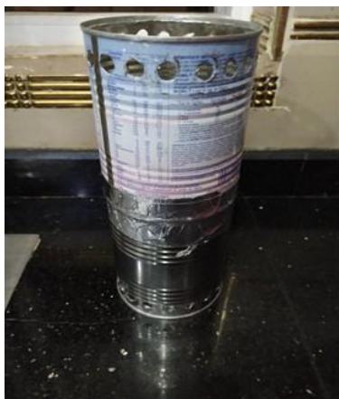
Figure II.7 : connexion entre les deux boîtes
