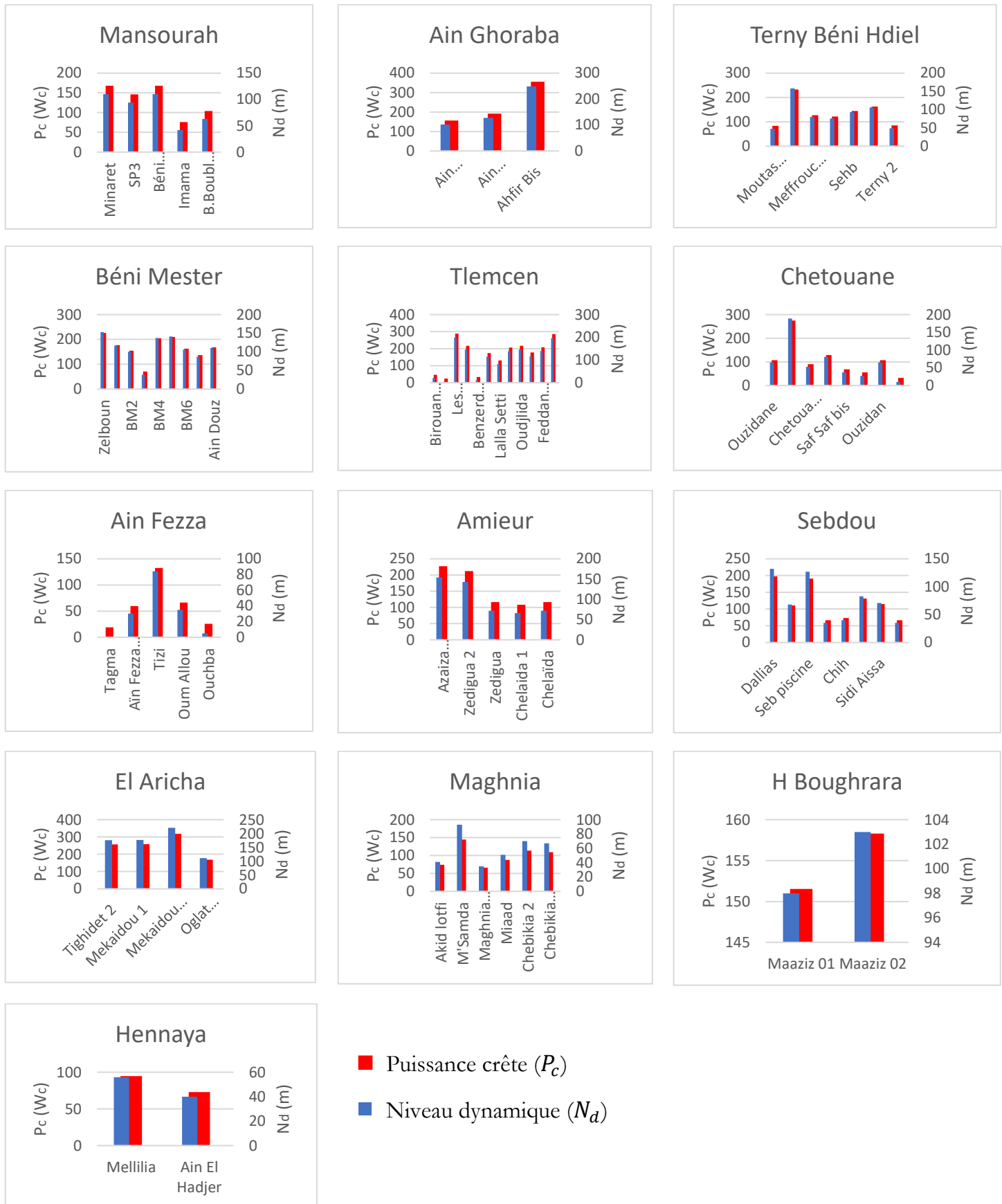
Figure 2 : Puissance crête nécessaire pour chaque forage de treize communes de la wilaya de Tlemcen (Petite consommation)
