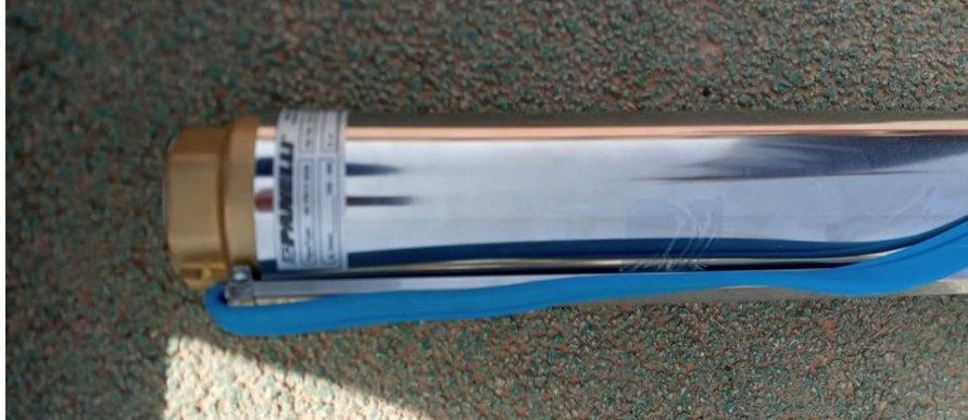
Figure 4 : Pompe utilisé actuellement pour pomper l'eau de forage de la piscine semi olympique de Seb dou
