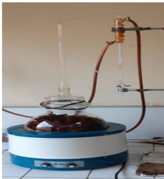
Figure 10 : Appareil d'extraction des huiles essentielles type Clevenger.
