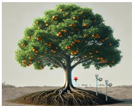
Figure 33 :représentation des dimensions d'installation des tensiomètres (réalisation personnelle, 2025)
