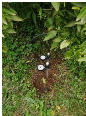
Figure 32 :tensiomètres installés dans le sol ( photo personnelle, 2025)
