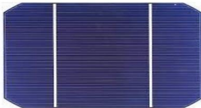
Figure 1.9 : Cellule solaire à base de Silicium monocristallin [1],[28]
