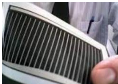
Figure 1.14 : Cellule solaire au tellure de CiGS [2],[37]
