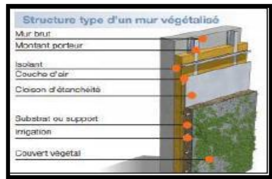
Figure 183: coupe d'un mur végétalisé Source : http://www.adivet.net
