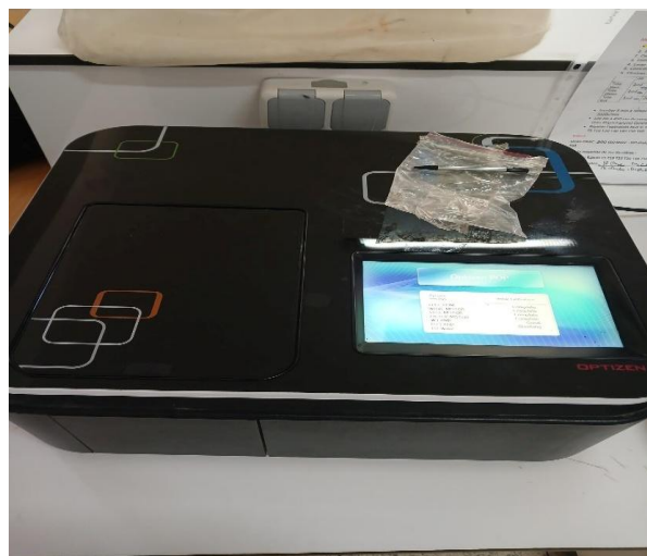
Figure 20 : La manipulation de l'acide ascorbique et la lecture dans le spectrophotomètre.
