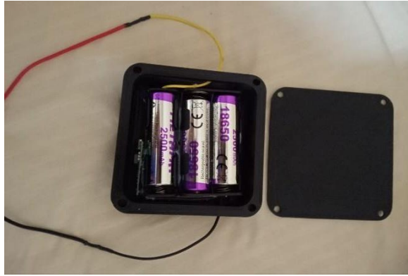
Figure III.6 : Système d'alimentation par batteries utilisé pour le fonctionnement de la main prothétique
