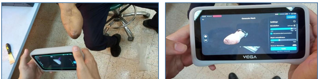
Figure III.10 : Scan 3D du moignon pour la conception de la prothèse
