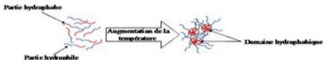
Figure I.13 : Méthode de synthèse des hydrogels par interactions hydrophobiques [63]
