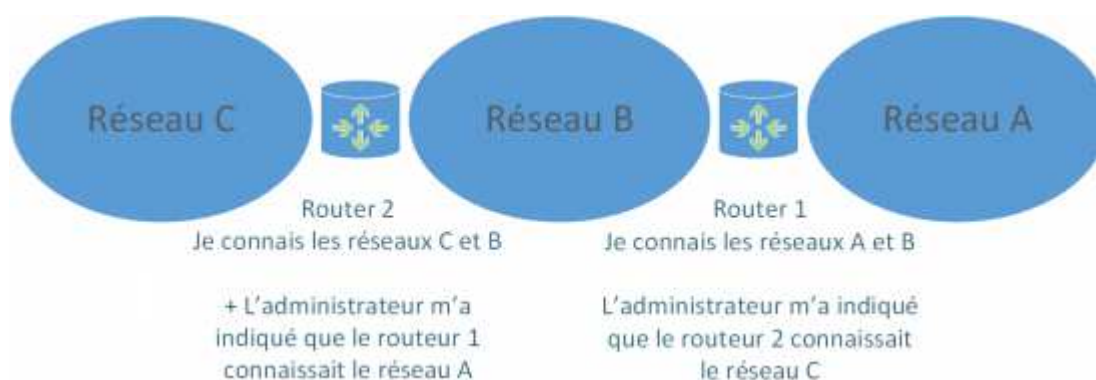
Figure II.8 : Fonctionnement de routage statique.
