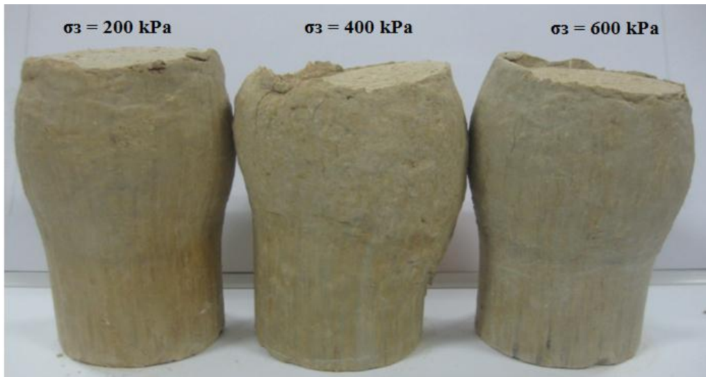
Figure 3-29. États des échantillons compactés statiquement après cisaillement
