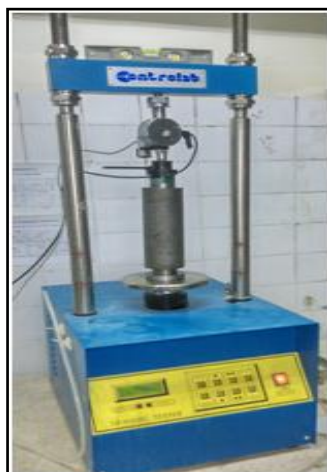
Figure 3-12. Dispositif du compactage statique.
