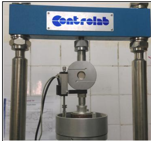
Figure 3-8. l'essai oedométrique à teneur en eau constante.
