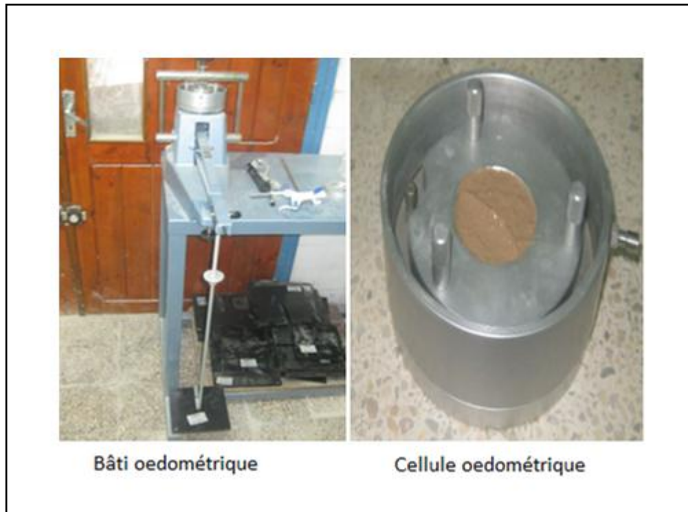
Figure 3-5. Essai oedométrique sur une pâte saturée
