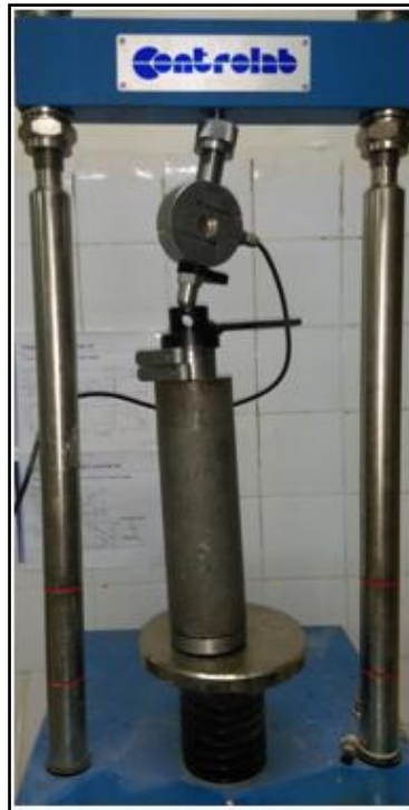
Figure 3-9. Problème de guidage de piston de compactage
