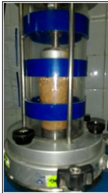
Figure 3-23. Le dispositif de l'essai de la compression simple
