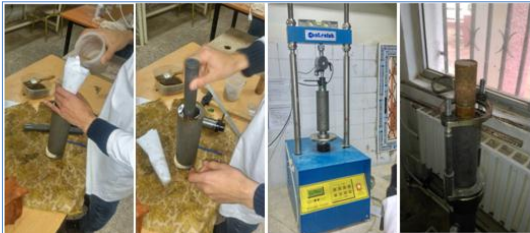
Figure 3-6. Mode opératoire du compactage statique
