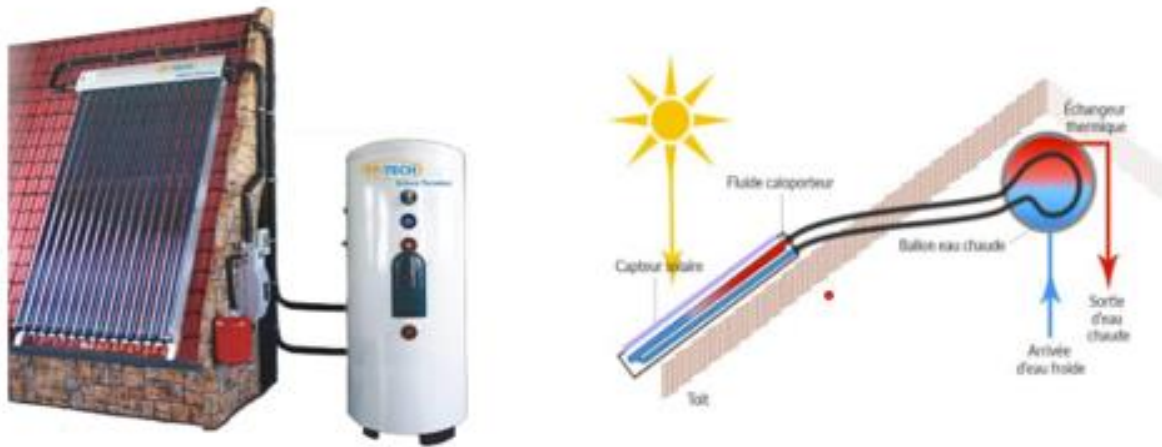
Figure I.2: Chauffe-eau solaire thermosiphon à éléments séparés
