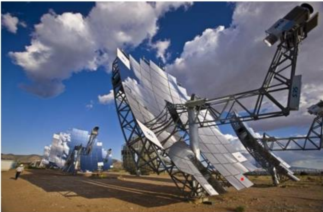
Figure I.11: Paraboles solaires Dish-Stirling testées à Albuquerque au Nouveau-Mexique
