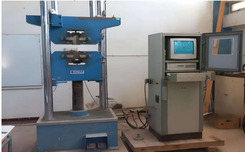
Figure 3.11. Machine de traction CONTROLAB modèle H000 3- 600 KN
