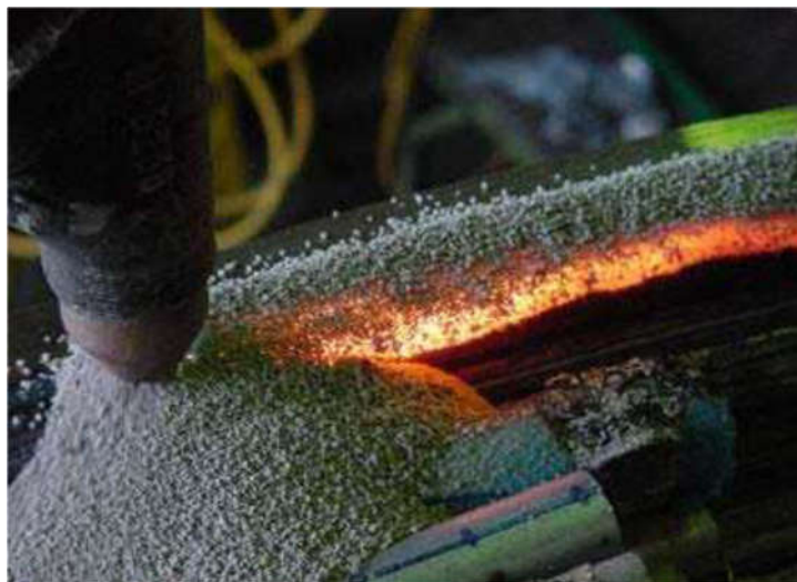
Figure 1.4. Dépôt du flux du procédé SAW
