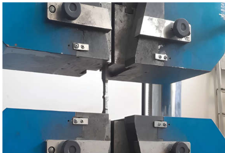
Figure 3.12. Eprouvette de traction avant la rupture dans la machine de traction
