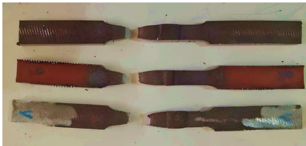
Figure 3.15. Photos des éprouvettes soudées après la rupture
