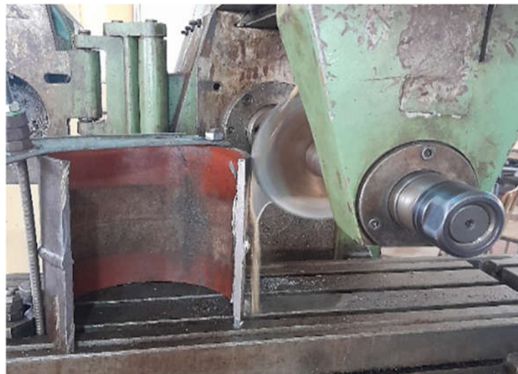
Figure 3.5. Découpage des éprouvettes brutes
