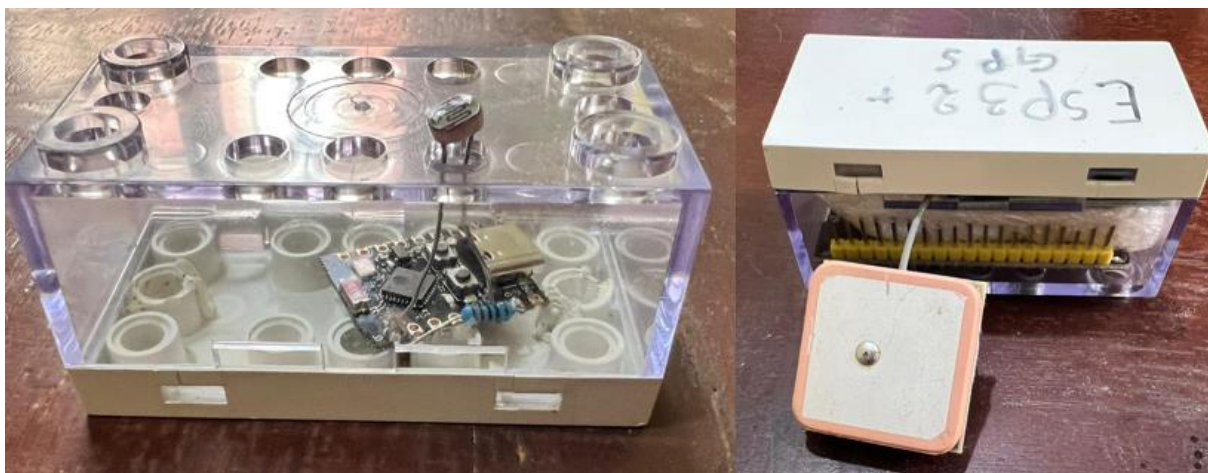
Figure IV.9 Boîtiers d'encapsulation choisis pour l'intégration du prototype
