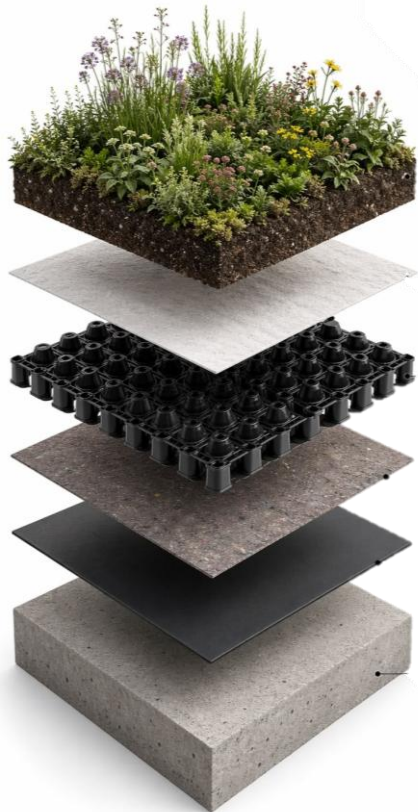
Détail technique 02 : Toiture végétalisée
