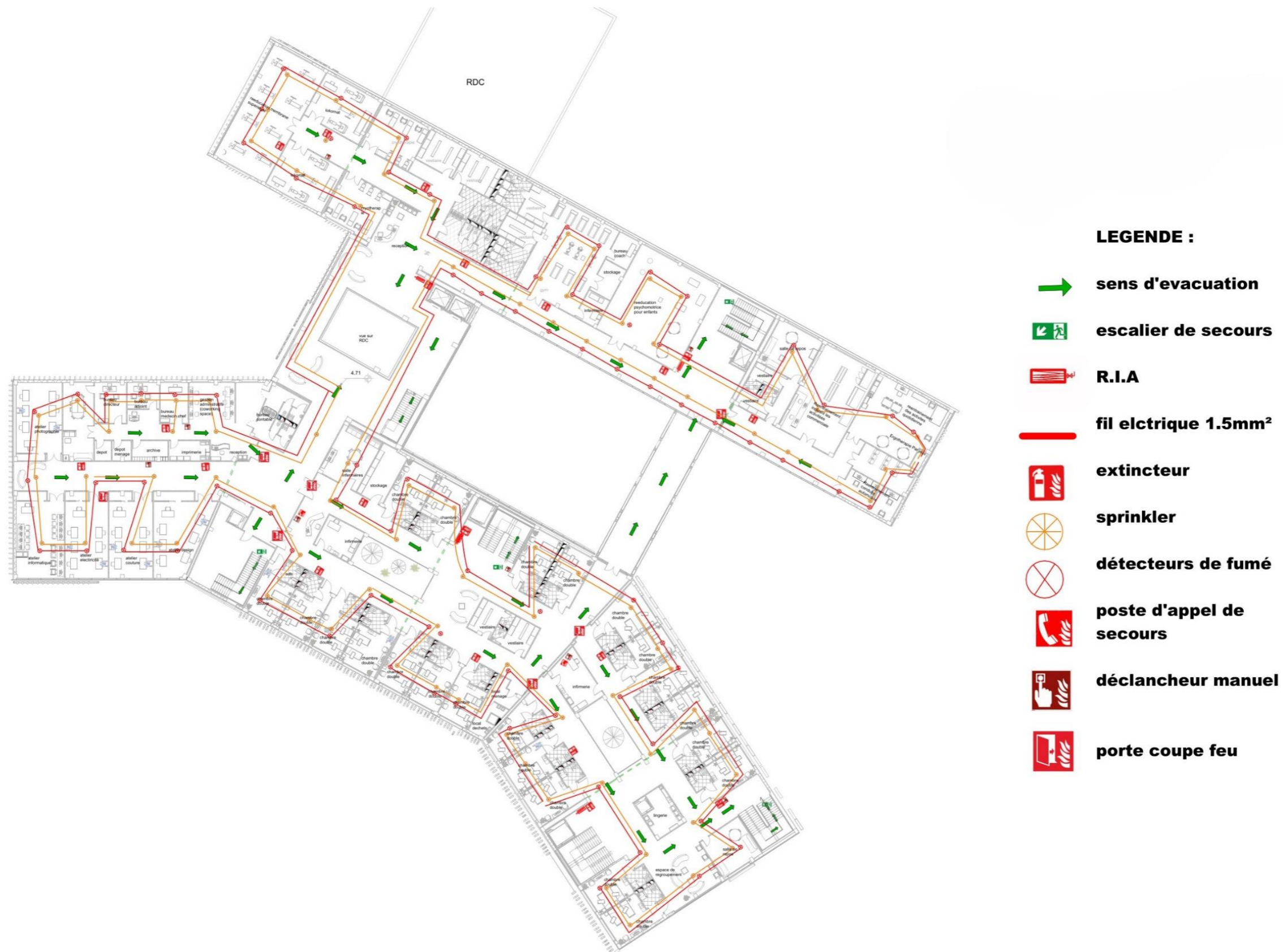
Figure 212:Plan etage1 anti incendie Source Auteur
