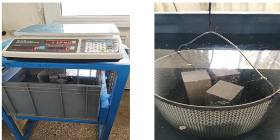
Figure 2.19. Essai pesée hydrostatique.
