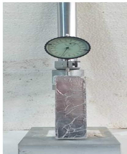
Figure 2.22.b. Mesure du retrait endogène.
