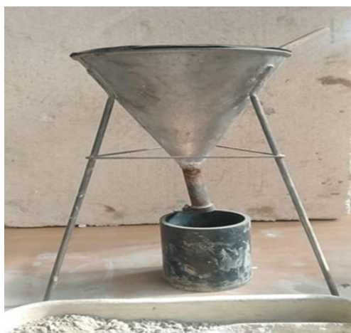
Figure 2.1. Détermination de la masse volumique apparente.
