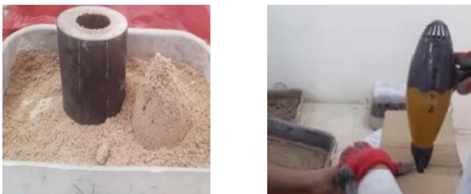
Figure 2.11. Essai d'absorption du sable.
