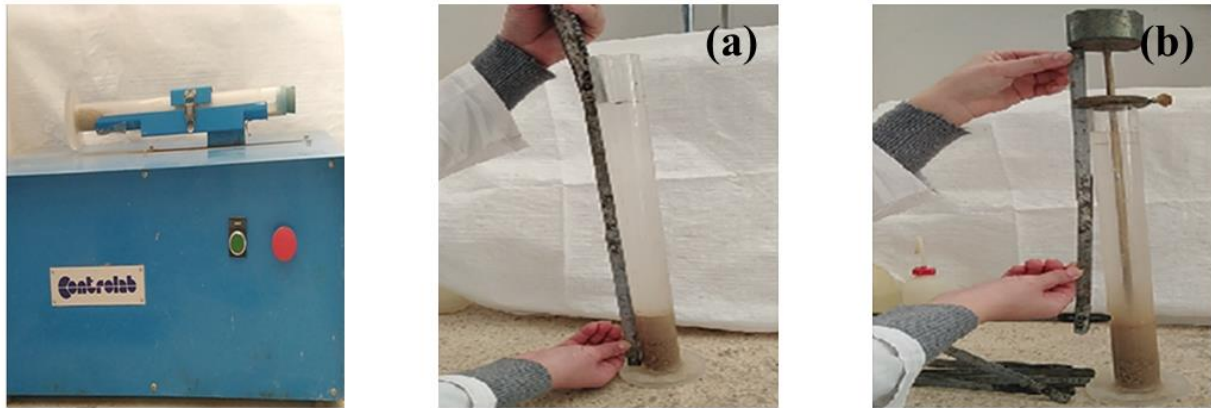
Figure 2.7. Essai équivalent de sable : (a) ESV, (b) ESP.
