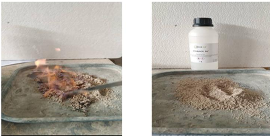
Figure 2.10. Essai teneur en eau.
