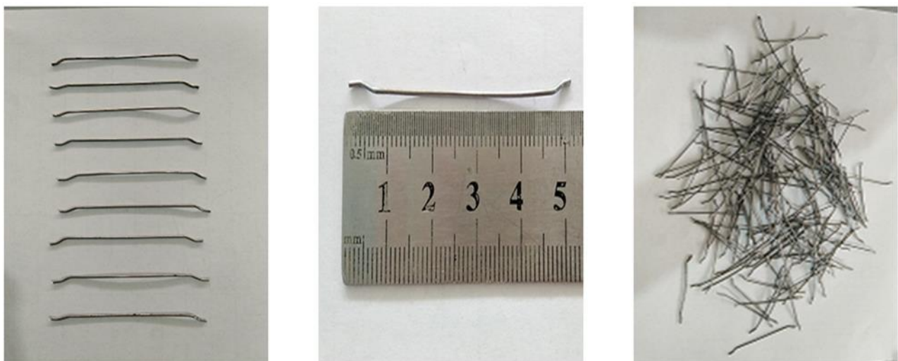
Figure 2.14. Fibres métalliques utilisés.
