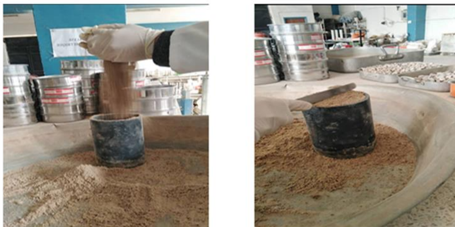
Figure 2.8. Essai foisonnement du sable.
