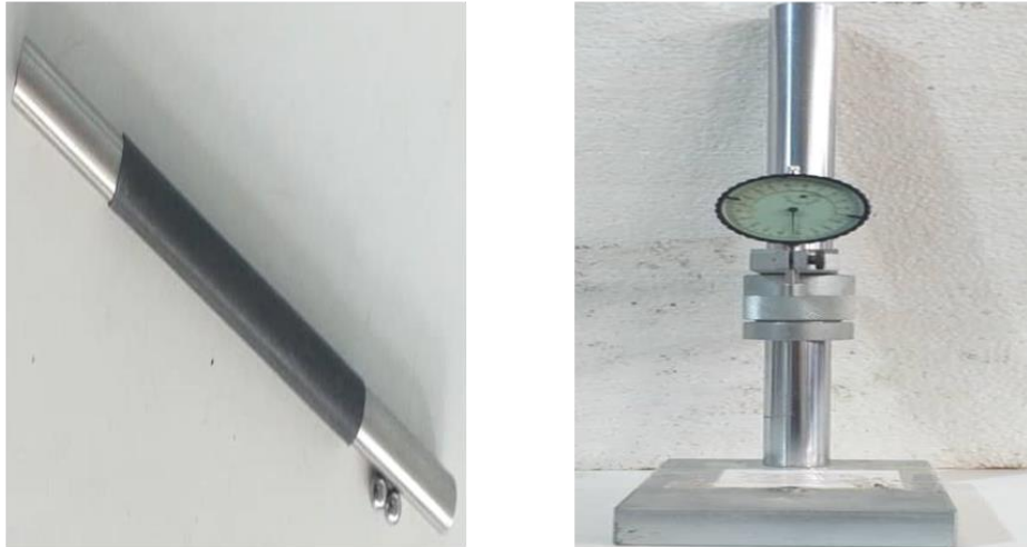
Figure 2.21. Rétractomètre et ses composants – Etalon et billes.
