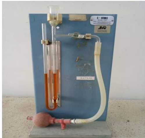
Figure 2.4. Perméabilimètre de Blaine Manuel.
