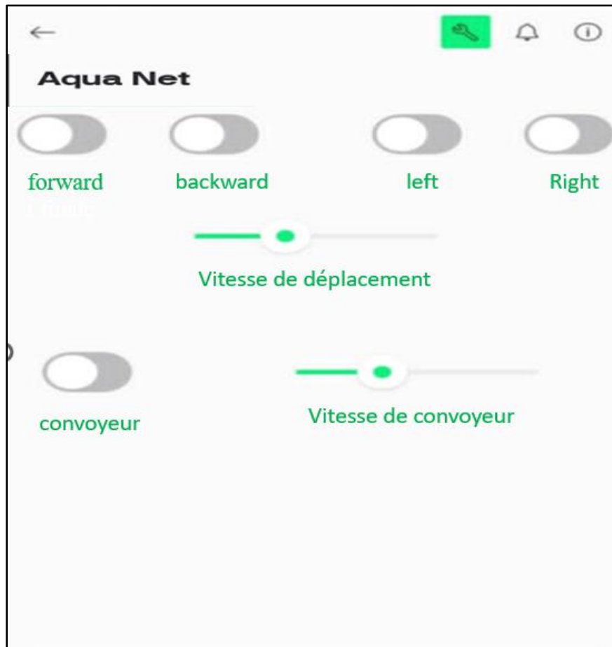
Figure III.13. Interface de commande du système via l'application Blynk
