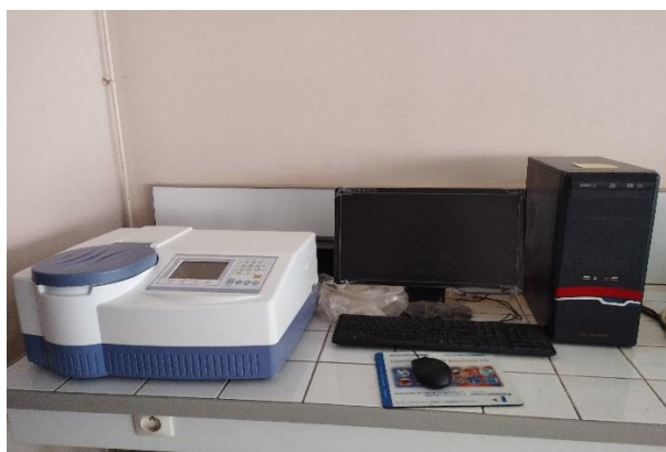
Figure II.1 : Spectrophotomètre UV-Visible OPTIZEN 2120
