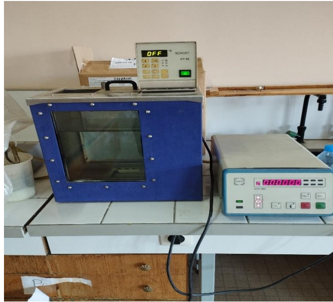
Figure II.2 : Un Ubbelohde viscosimètre à capillaire
