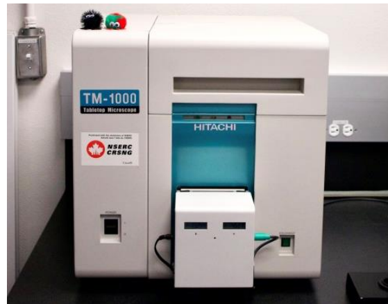
Figure II. 4 : La microscopie électronique à balayage Hitachi TM-1000
