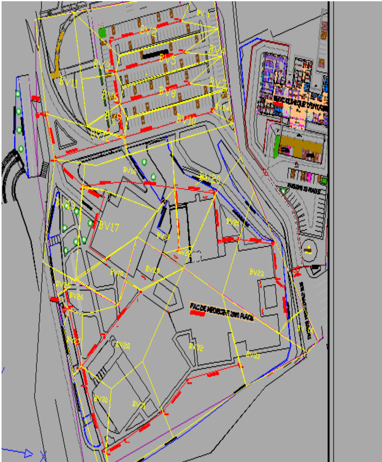
Figure III.3 : décomposition des sous bassins sur AutoCAD
