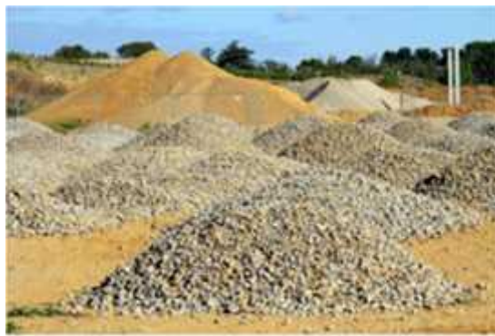
Figure n°1 : Constituant d'un mélange bitumineux (Granulats).
