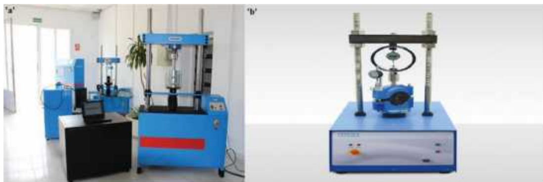
Figure n°5 : Presse d'essai 'a' Duriez, 'b' Marshall (NF P 98-251-1 & 2).
