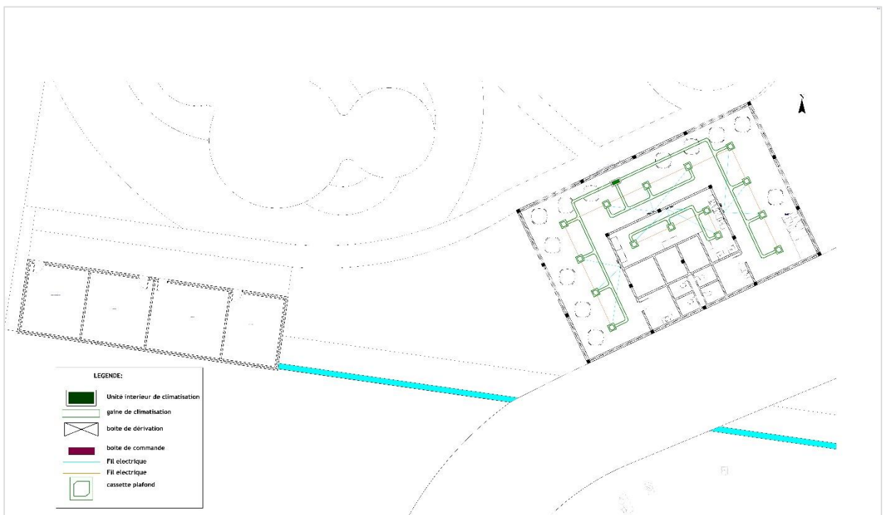
Figure 113. Plan climatisation du restaurant
