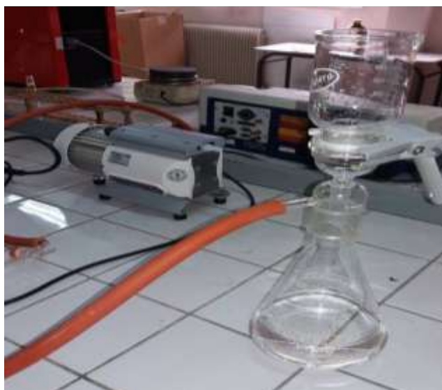
Figure II. 4 : Unité de microfiltration
