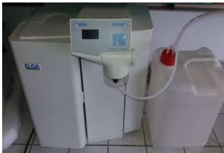
Figure II.3 : Appareil de production d'eau ultra pure
