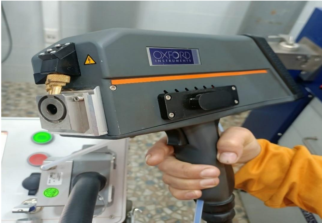
Figure IV.1 : Pistolet portable pour l'émission optique par plasma. 57
