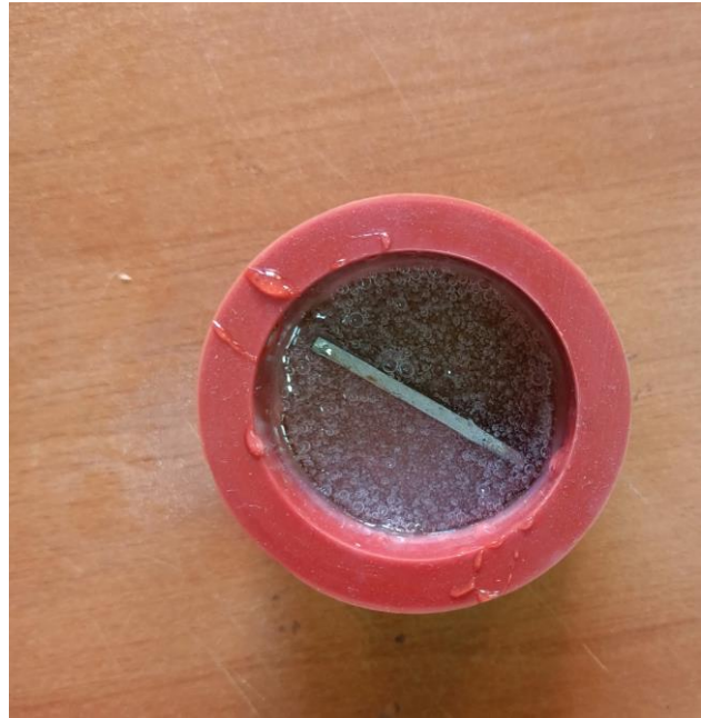
Figure IV.5 : Préparation d'échantillant dans un moule de silicone. 61
