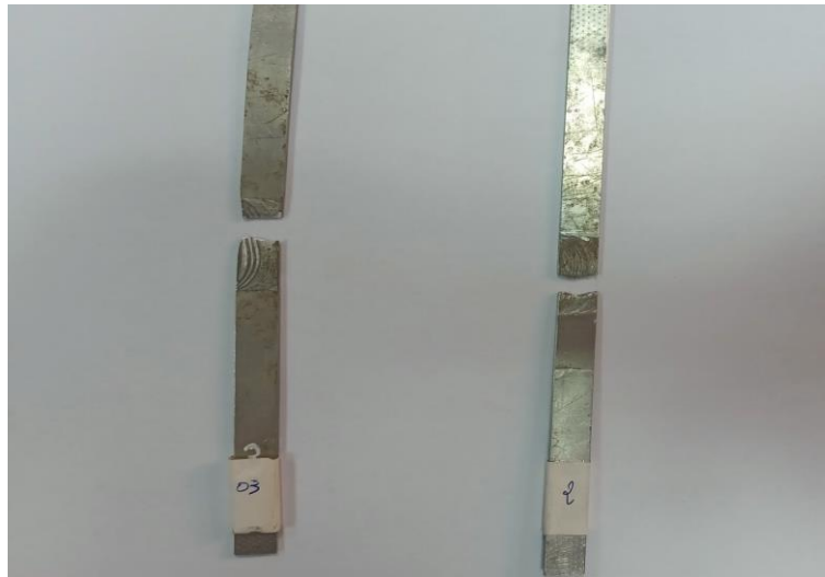
Figure IV.15 : Eprouvettes après l'essai de traction.71
