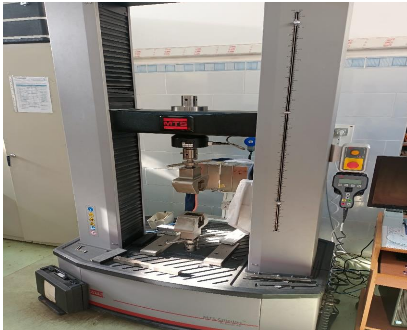
Figure IV.14 : Machine d'essai de traction à commande numérique.70
