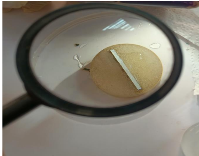
Figure IV.9 : application de l'attaque chimique sur l'échantillant.65
