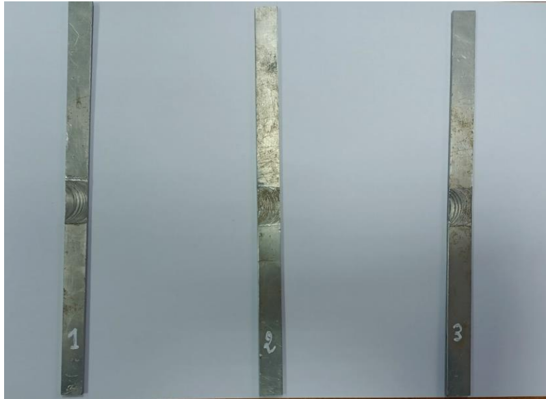
Figure IV.13 : Eprouvettes de traction API 1104.69
