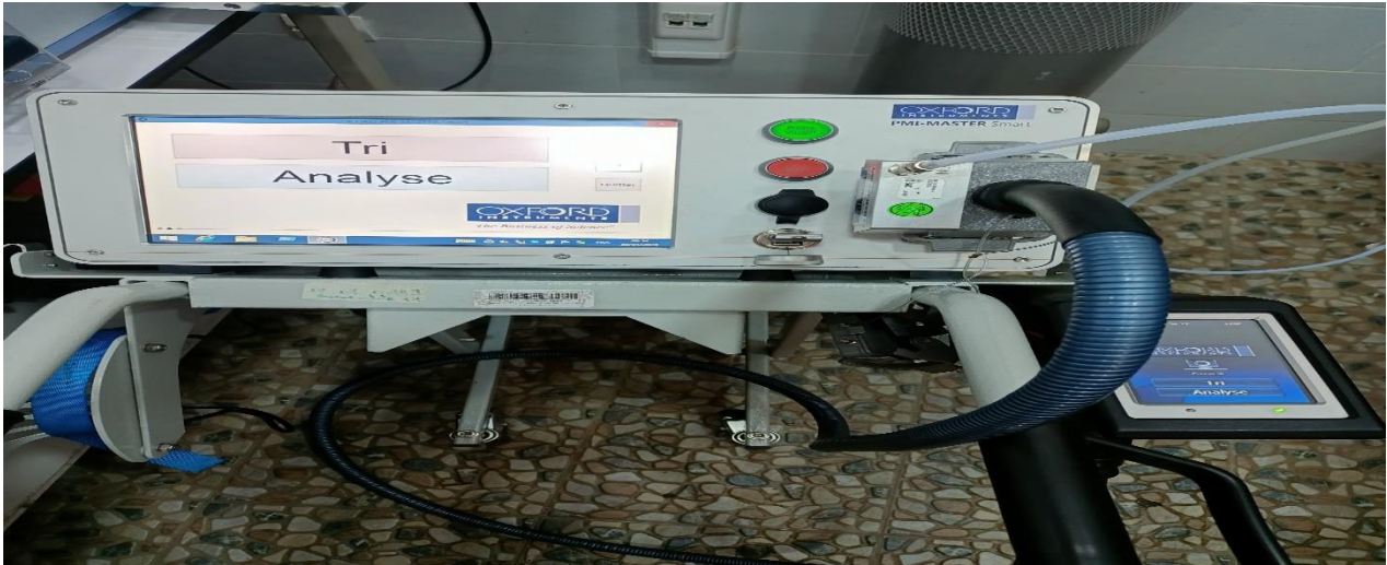
Figure IV.2 : Appareil responsable de contrôler les paramètres d'opération LIBS. 58
