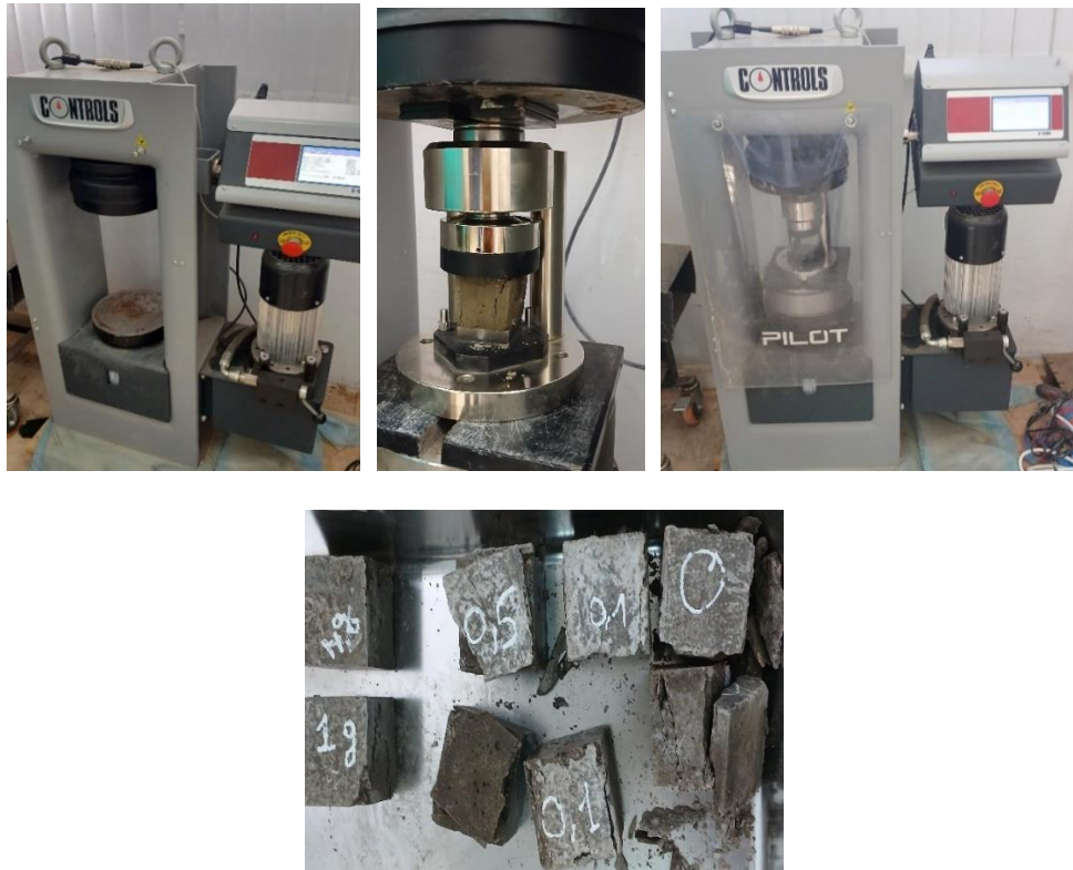
Figure 3.15 : Etapes de L'essai de résistance à la compression.
