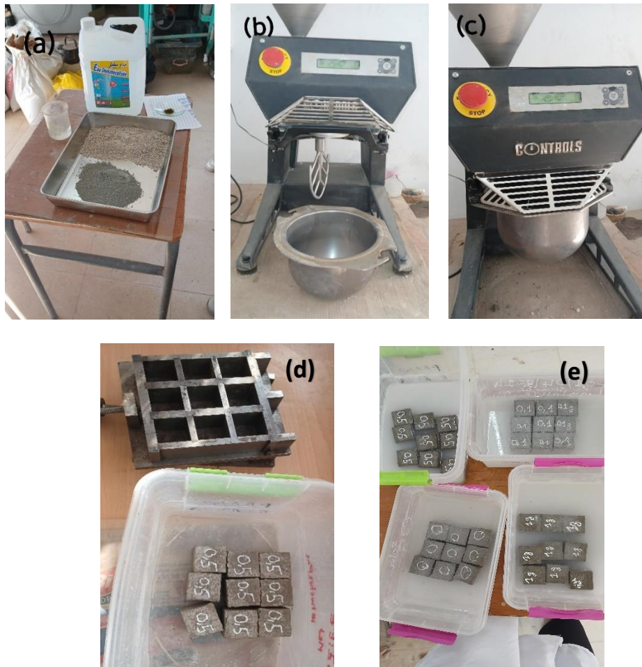
Figure 3.9 : Etapes de fabrication de mortier ,(a) Préparation des matériaux ,(b) Malaxeur ,(c) Malaxage ,(d) Moulage ,(e) Conservation.
