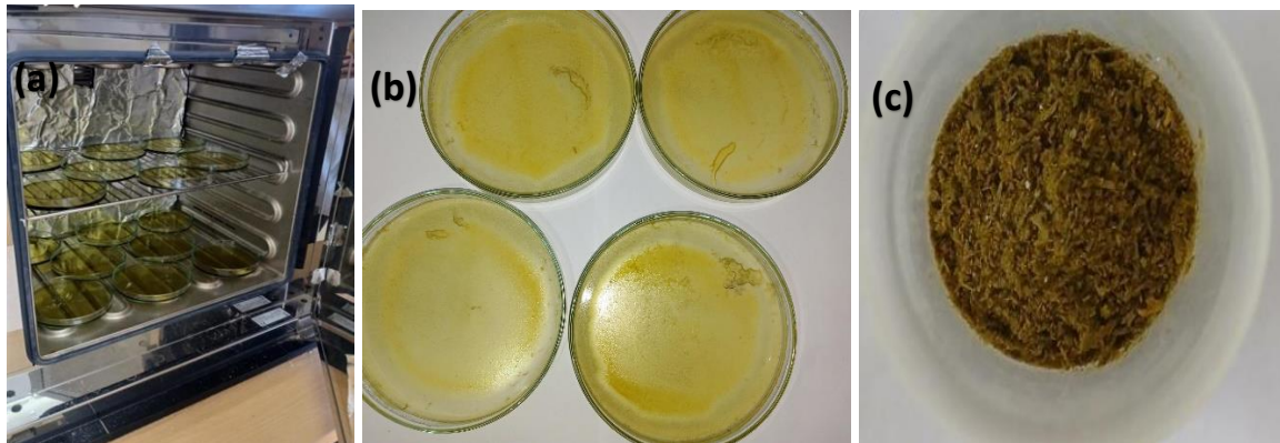
Figure 3.3 : Les étapes de préparation d'inhibiteurs utilisés, (a) Séchage par étuvage (b)Evaporation du solvant ,(c)Récupération de l'extrait sec.
