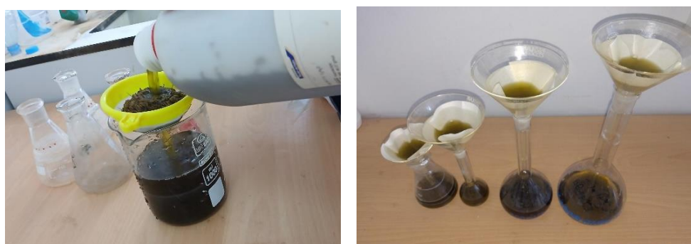
Figure 3.2 : Etapes de filtration de l'extrait en inhibiteur.
