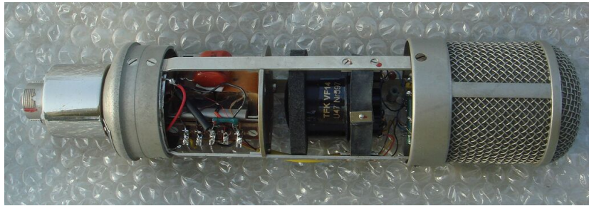
Figure 1.11 – Schéma d'un microphone à condensateur [17].
