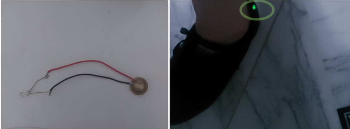
Figure 3.5 – Test d'alimentation d'une diode DEL par un seul capteur piézoélectrique.
