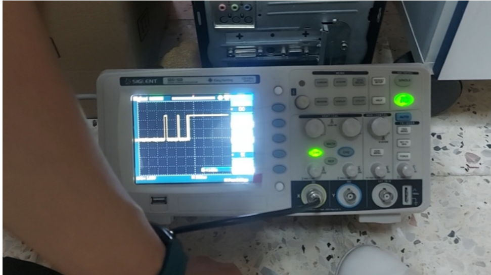
Figure 3.11 – Le signal obtenu aux bornes du condensateur.
