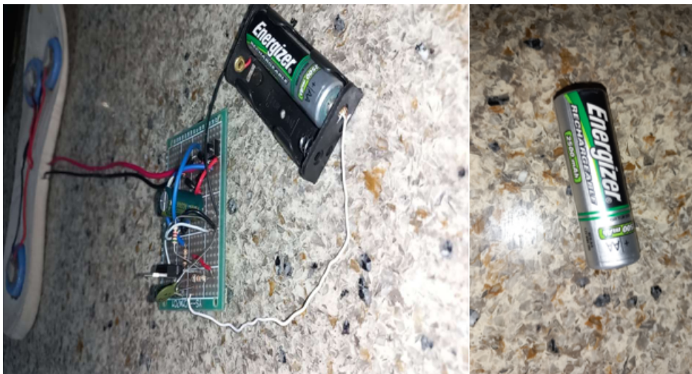
Figure 3.14 – Partie stockage en utilisant une batterie Lithium-Ion .
