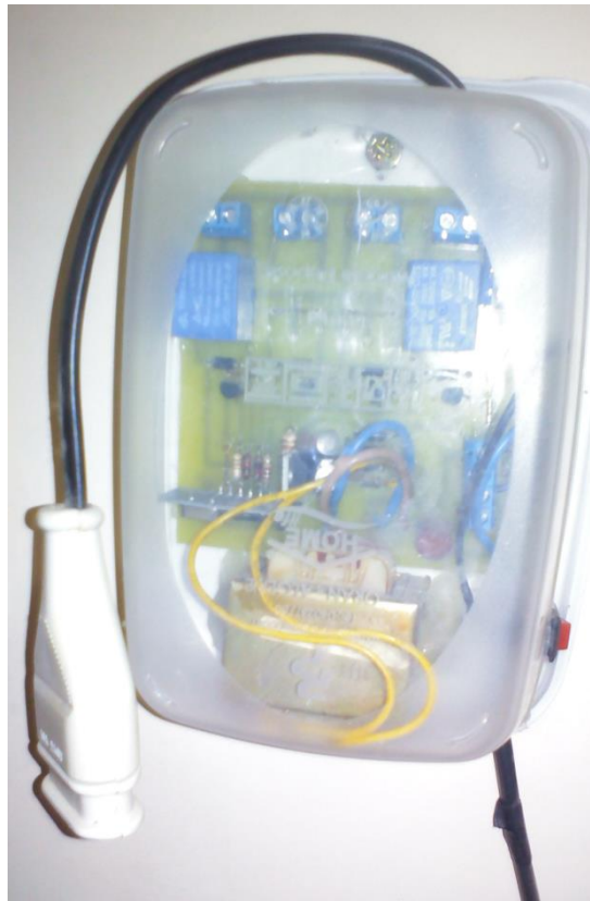
Figure III-8 : Produit obtenu après emplacement et soudure des composants
