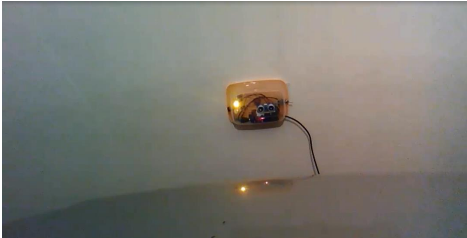
Figure IV-18: Fonctionnement du système d'aide au stationnement quand la distance séparant la voiture et le mur est comprise entre 30cm et 20cm.
