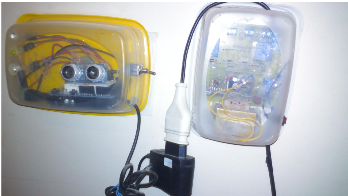
Figure IV-20: Photo du système mural piloté à distance pour aide au stationnement de véhicule que nous avons réalisé, placé sur un mur
