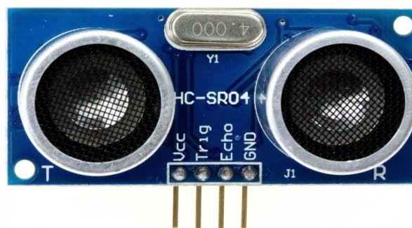
Figure IV-6 : Présentation du module HC-SR04
