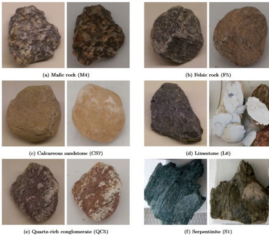
Fig I.17. Changement de l'état des roches avant et après 20 cycles thermiques
