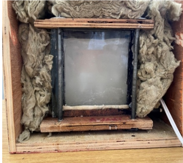
Fig III.2. Isolation de la cavité thermique
