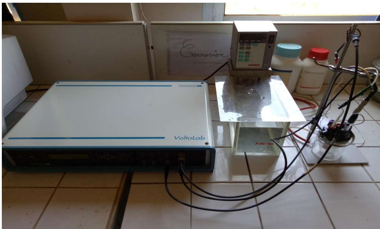
Figure II.4 : Dispositif expérimental des mesures électrochimiques.
