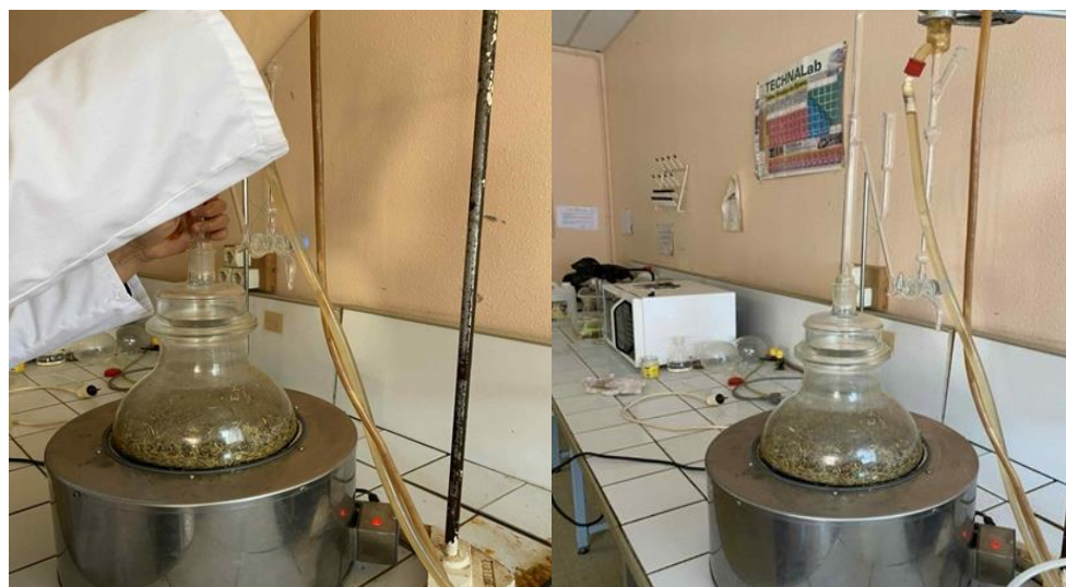
Figure 19 : Dispositif expérimental d'hydrodistillation de type Clevenger pour l'obtention des huiles essentielles
