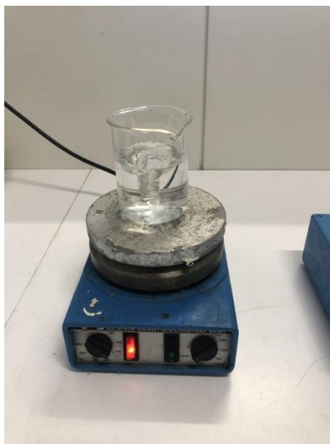
Figure2.6 : Agitateur magnétique chauffant avec bécher en agitation
