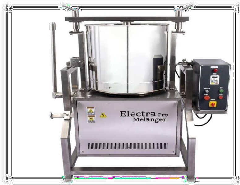
Figure 3.5 (site 05) : machine assure le mélange, le broyage et le tempérage
