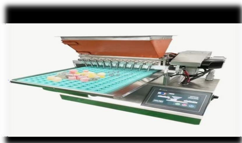
Figure 3.8 (site 08) : Machine de dosage et de dépôt du chocolat
