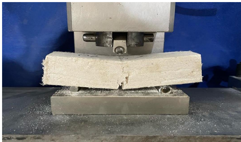
Figure 45: Dispositif pour l'essai de résistance à la traction
