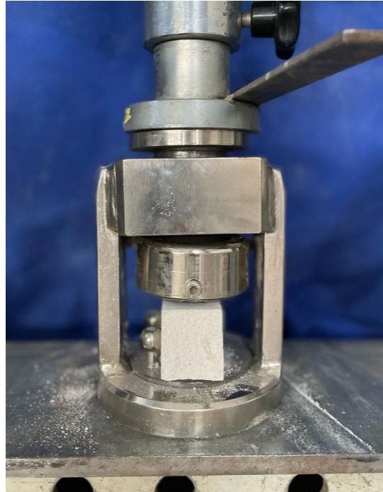
Figure 46: Dispositif pour l'essai de résistance à la compression
