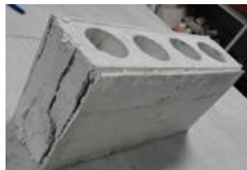
Figure 14: État et fissures du bloc après le test de compression
