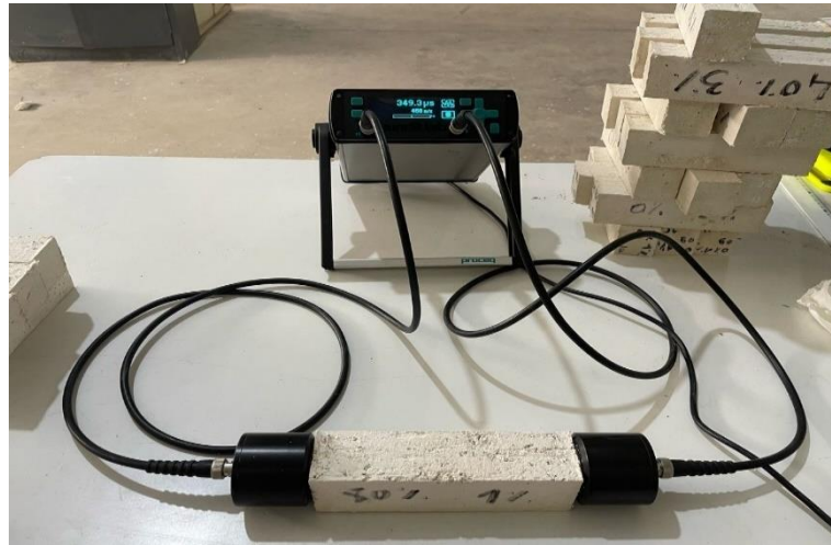
Figure 50: Appareil pour essai de vitesse des ultrasonsI
