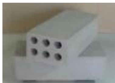
Figure 13: Briques pleines à base de plâtre avec six trous ronds symétriques, mesurant 85 \times 55 \times 185 \text{ mm}^3 [17]
