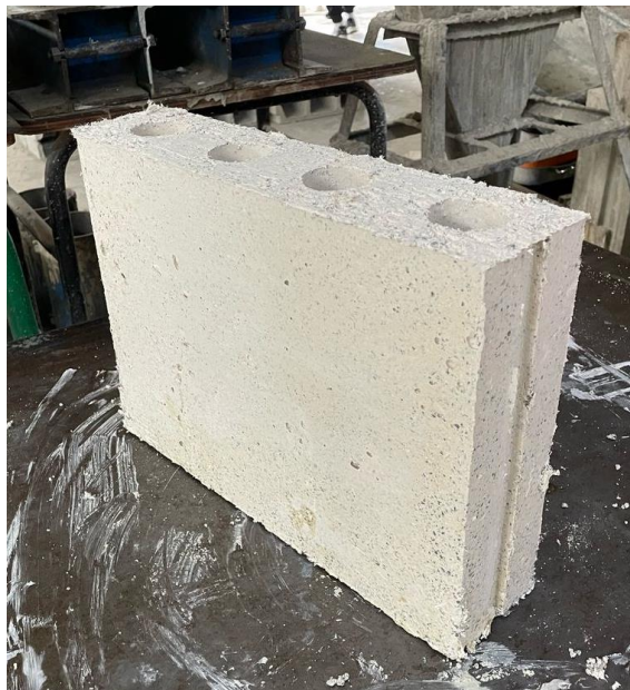
Figure 51 : Bloc alvéolaire ( 33 \times 25 \times 8 \text{ cm}^3 )
