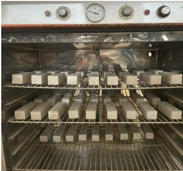
Figure 48: Les échantillons dans l'étuve
