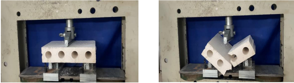
Figure 75 : L'essai de traction sur le bloc sans fibre PP
