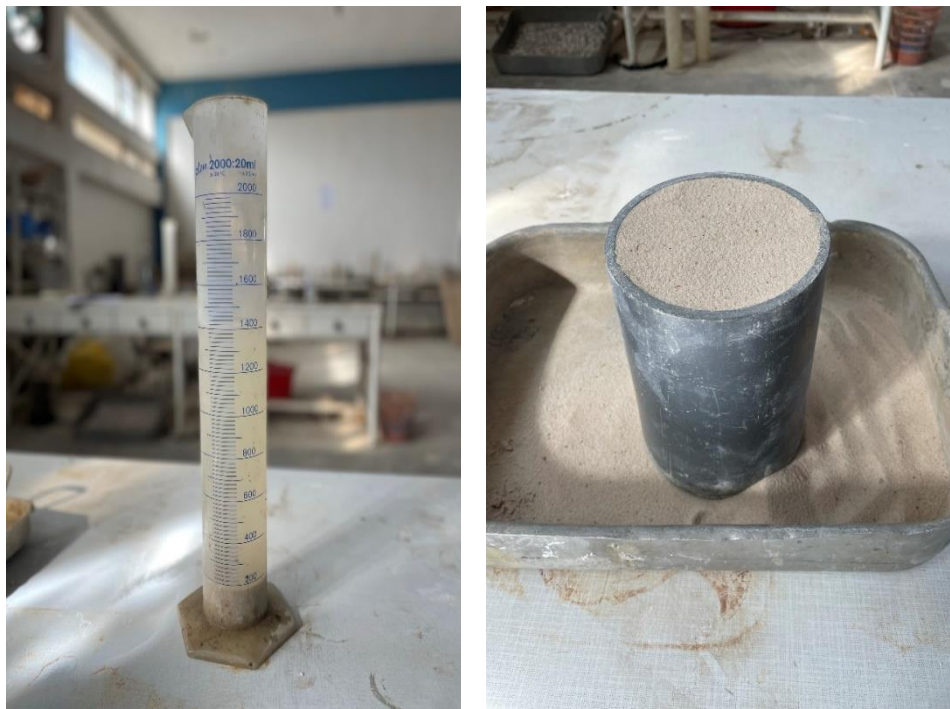
Figure 29: Masse volumique du sable
