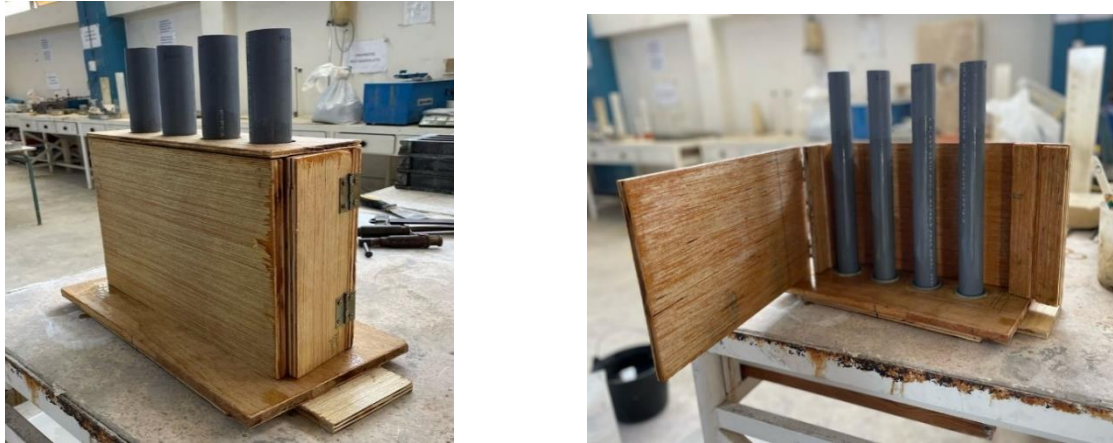
Figure 38: Moule du bloc alvéolaire
