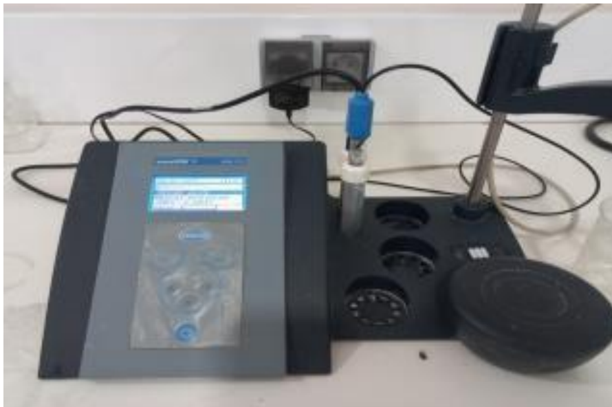
Figure II-42 pH-mètre de model (HACH Sension+ MM374)
