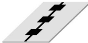
Figure I.12: Alimentation du réseau d'antennes en série [15].
