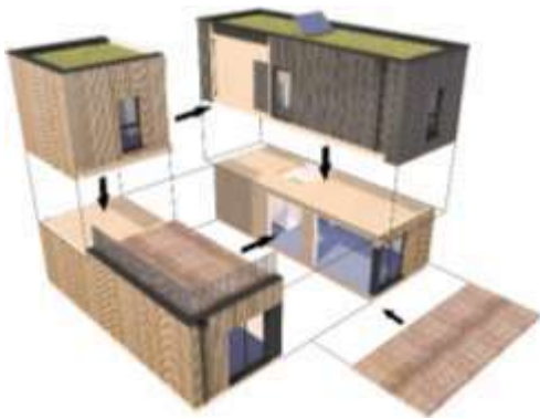
Figure 21:Construction Modulaire « hors site »
